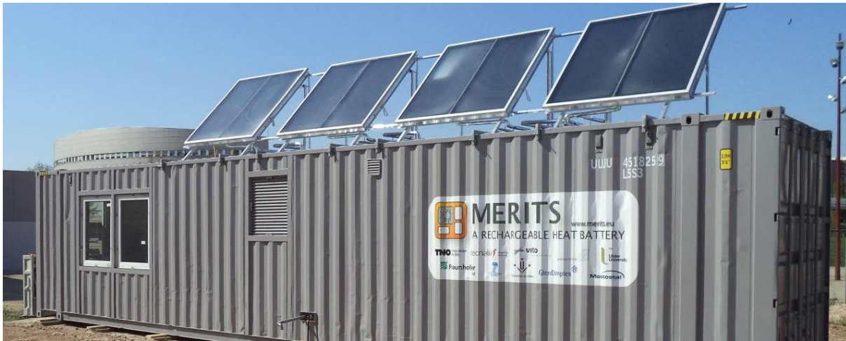
Proefopstelling warmteopslag in zout – Foto TNO
